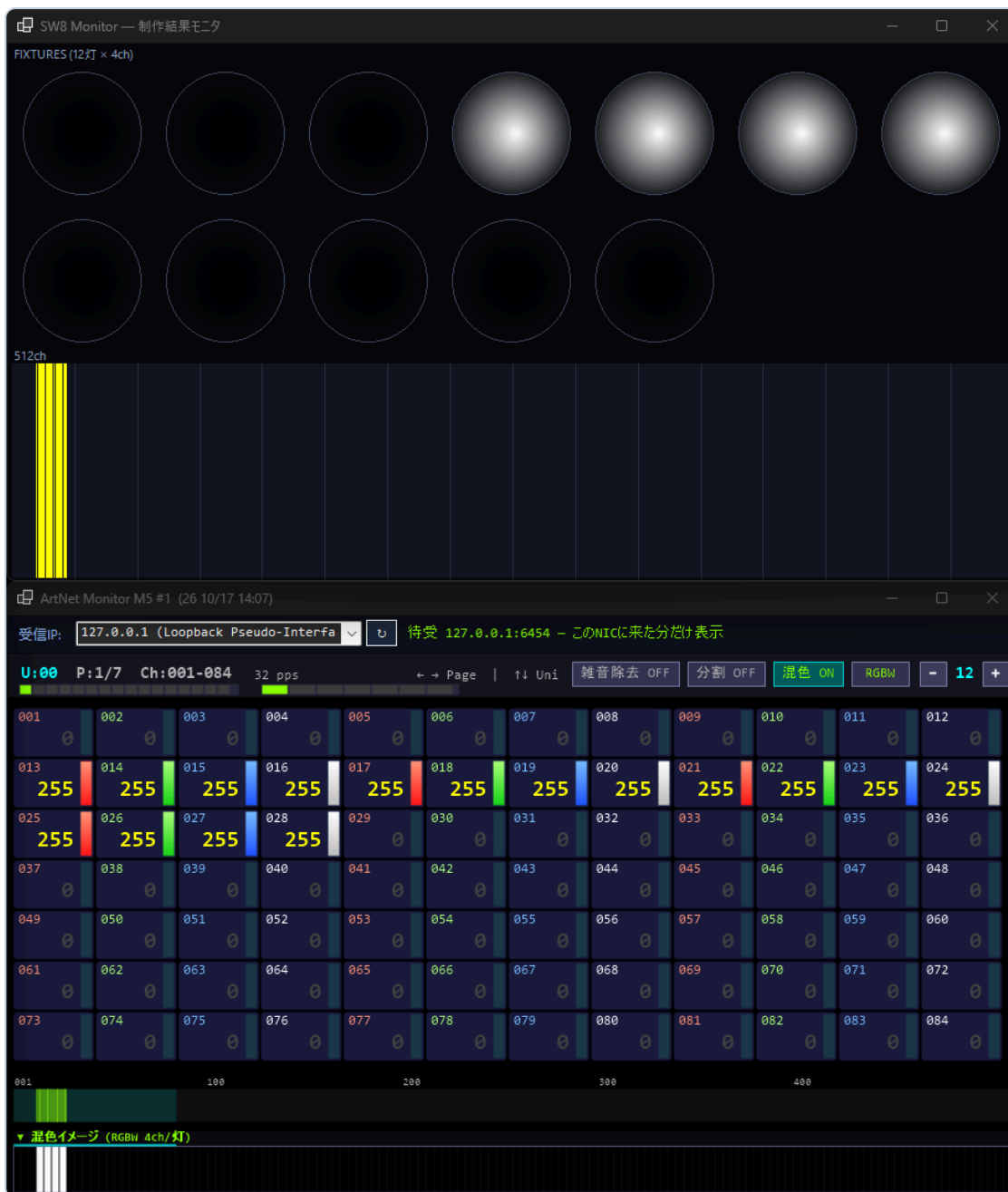
図 5 器具チェイス「1/3点灯」(12 台のうち 4 台をひとかたまりで点けて送る)
