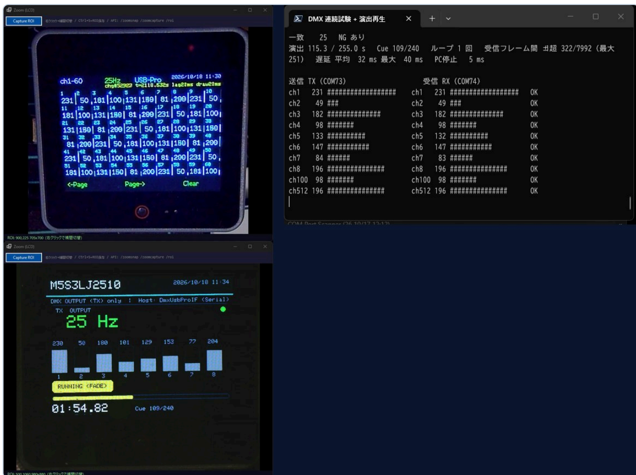
図 7 左 = 2 台の液晶(上 COM73「25Hz」・下 COM74「TX OUTPUT 25 Hz」)／ 右 = 試験の窓(全チャンネル OK)
