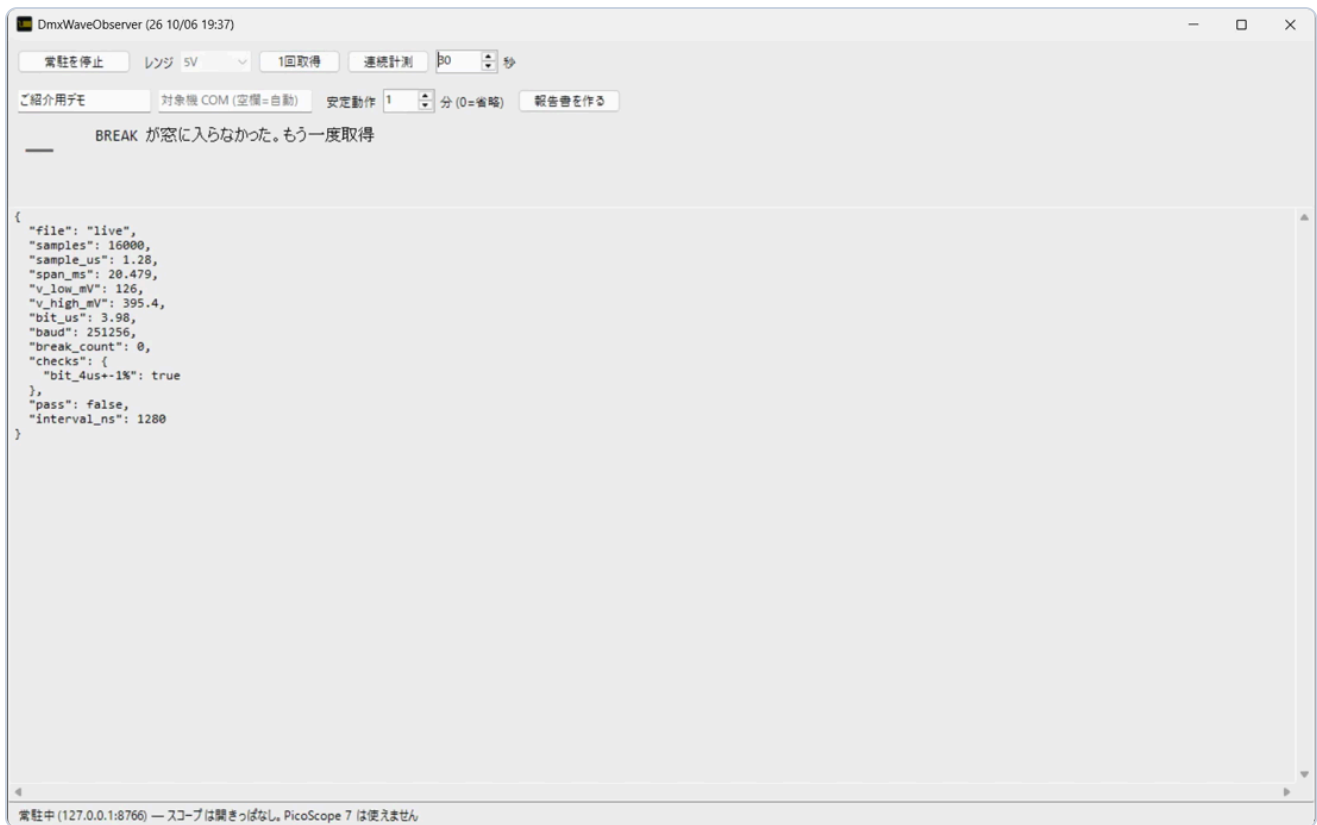
図 4 1回取得。この例は「BREAK が窓に入らなかった」— 故障ではない。もう一度押す
