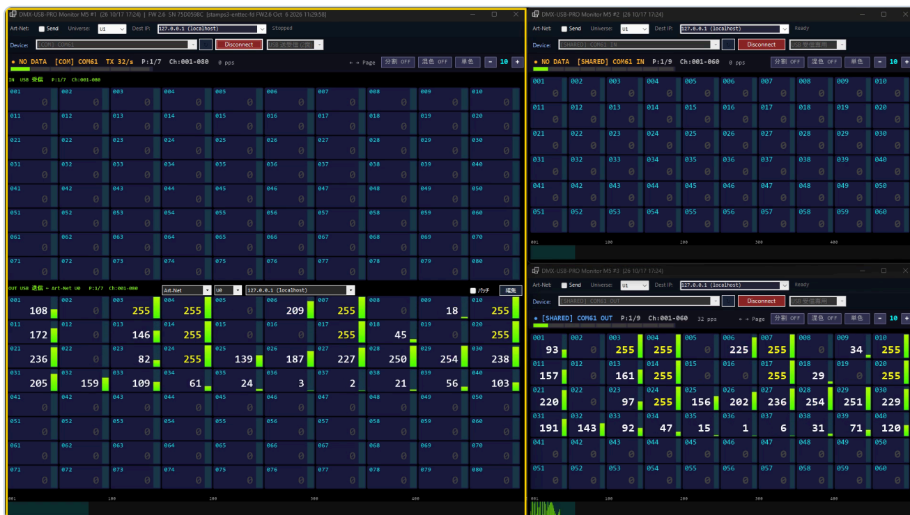
図 1 左が COM61(互換機)に送受信 2 面で繋いだ窓 #1、右上・右下が #1 の値を共有で読む窓 #2(IN)・#3(OUT)。下の面と #3 の値は、収録用の送り元から送った Art-Net(動画の録画から切り出し。黄色い枠は動画の目印)
