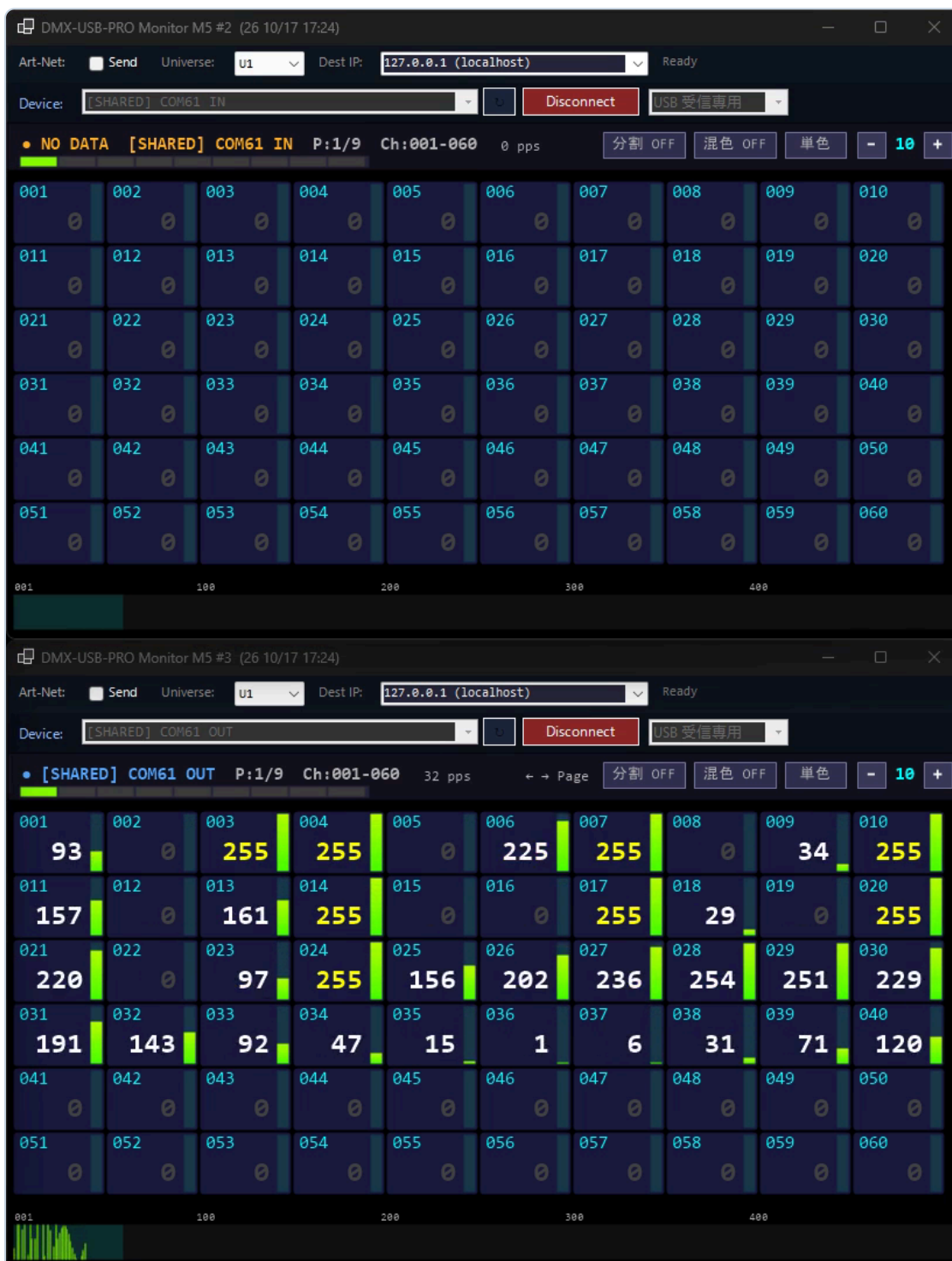
図 7 上が [SHARED] COM61 IN (入力に信号が無いので NO DATA)、下が [SHARED] COM61 OUT (#1 が COM61 へ送った値がそのまま出る)
