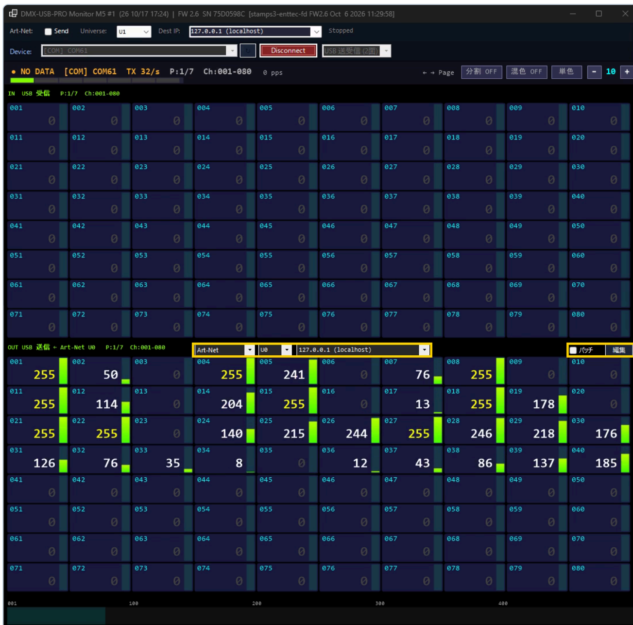
図 6 COM61 に送受信 2 面で繋ぎ、下の面に Art-Net U0(127.0.0.1 で受ける)を出しているところ。状態の行の TX が毎秒の送信数(この機器で毎秒 32 前後)。上の面(入力)は信号が無いので 0
