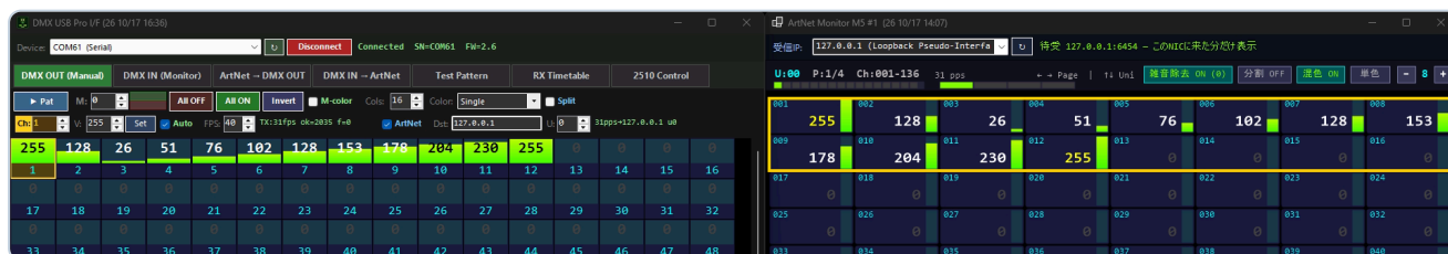
図 1 左が DmxUsbProIF(COM61 に接続して ch1~12 に値を入れたところ)、右が受信モニター ArtNetMonitorM5。DMX OUT の「ArtNet」で同じ値を 127.0.0.1 へも送り、右で受けている(動画の録画から切り出し。黄色い枠は動画の目印)
