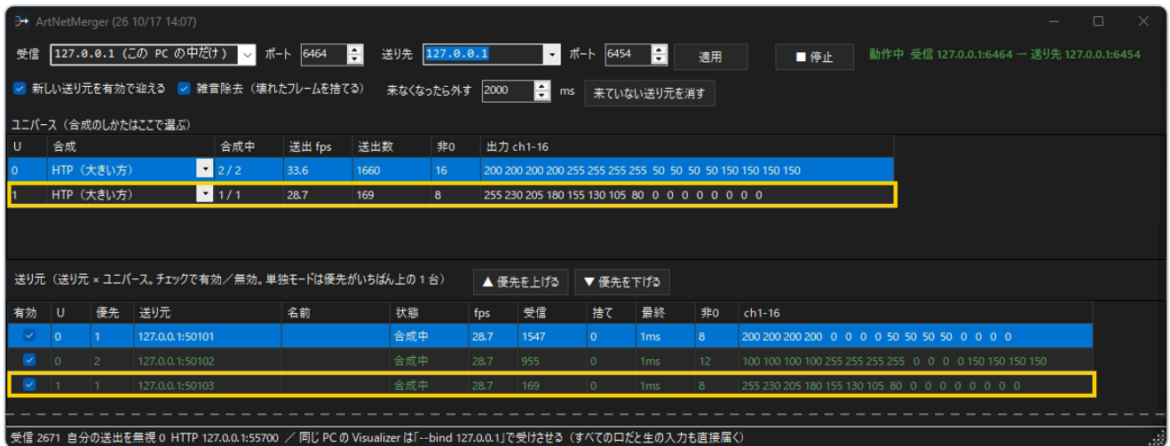
図 1 U0 を HTP で 2 台合成中、U1 は 1 台の画面(この例は試験用に、受信 127.0.0.1:6464 → 送り先 127.0.0.1:6454 で動かしたものを。黄色い枠は動画の目印。下の空いた所は詰めてある)
