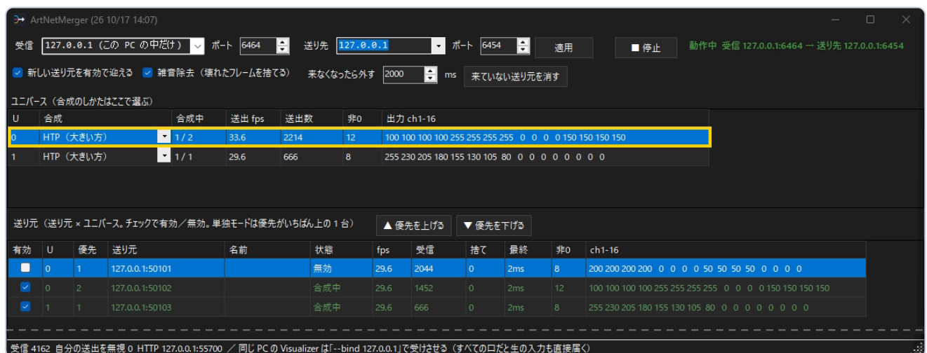
図 3 U0 の先頭の送り元(127.0.0.1:50101)のチェックを外した状態。状態は「無効」になり、ユニバース表の「合成中」が 2/2 から 1/2 に減って、出力は残った 1 台(127.0.0.1:50102)の値だけになった
